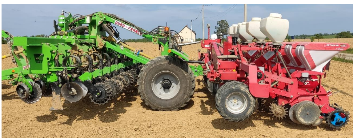
Strip-till Duro avec semoir monograine : une solution efficace pour protéger les sols et réussir son semis. (Montjean 53320, avril 2022)
