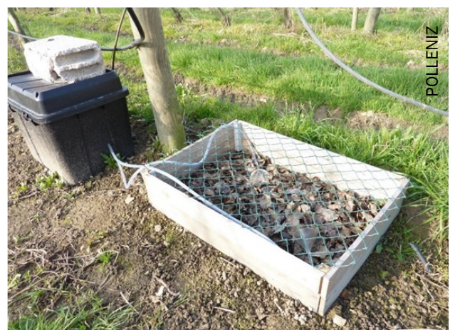
Capteur de spores de type Marchi sur lit de feuilles tavelées
