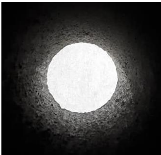
Buse usée, aspérités visibles et bords non lisses - + 1,1 mm par rapport au diamètre initial
