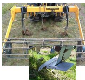
Cultiplot (Agrisem) Dents passés sous l'enherbement à 10 cm de profondeur
