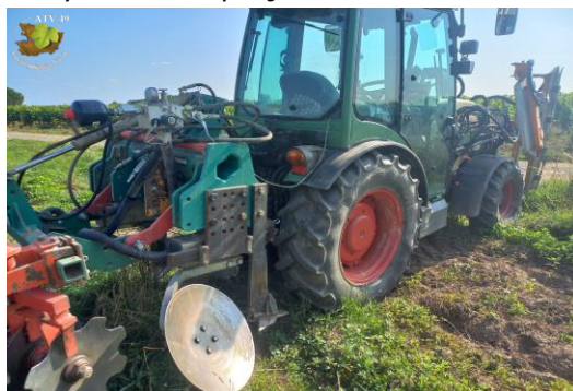
Combinaison d'outils pour, en un seul passage gérer l'inter-rang, les cavallons et rogner. Domaine des 2-Moulins.
