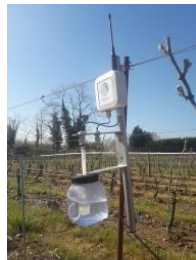
Station WeeFrost, outil prédictif des épisodes de gel sur 4 jours avec sonde de mesure de température humide.
