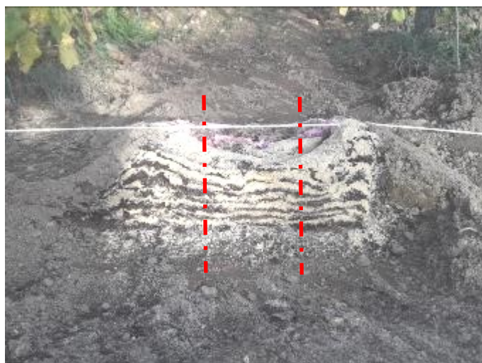
Sur cette photo, les pneus étaient gonflés à 1.7 bars. On remarque la déstructuration globale du profil avec un point de tassement prononcé sur la partie centrale du passage : création de tassement.
