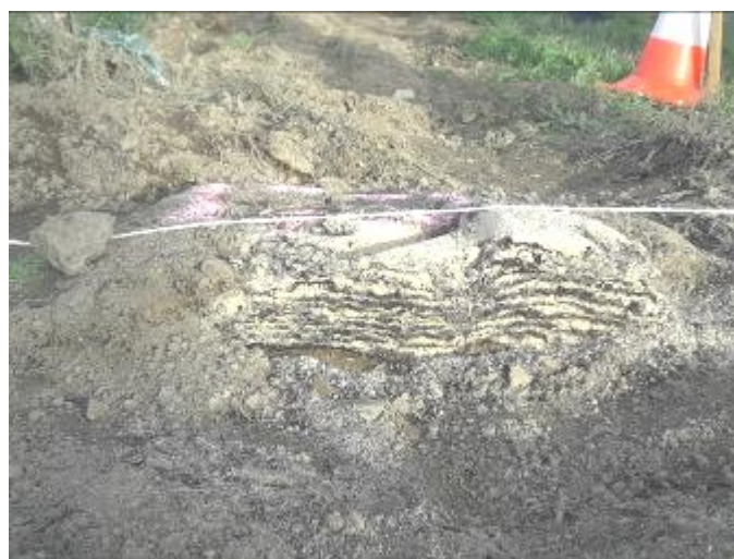
Sur cette photo, les pneus étaient gonflés à 1.0 bars. On remarque une répartition plus homogène de la masse sans effet de concentration : tassement limité.
