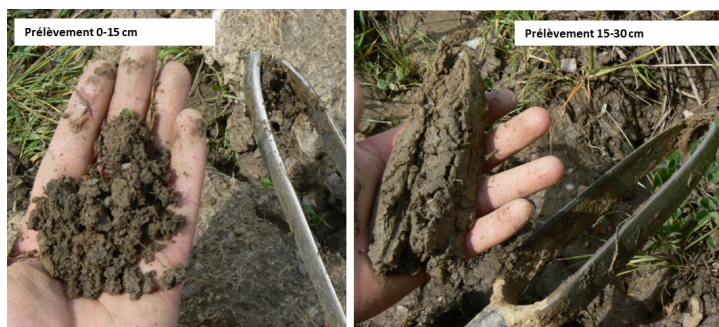
Photos montrant le test du ressuyage en surface et en profondeur. Source : Perrine DUBOIS (ATV 49).
