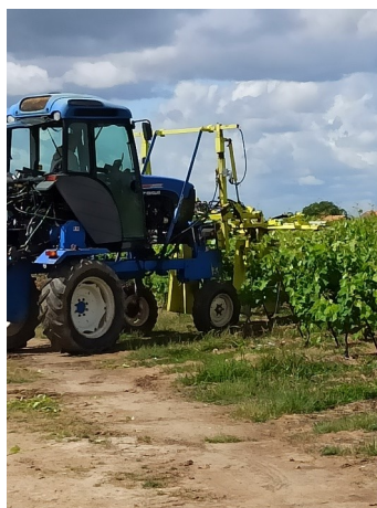
Rogneuse en pleine action. La pousse des rameaux ne laisse pas de temps morts.
