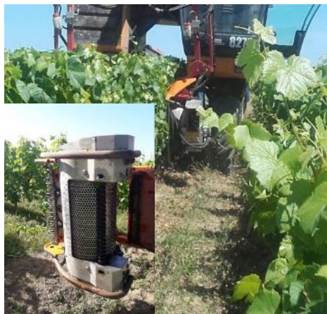
Effeuilleuse à rouleaux avec aspiration sur porteur.
